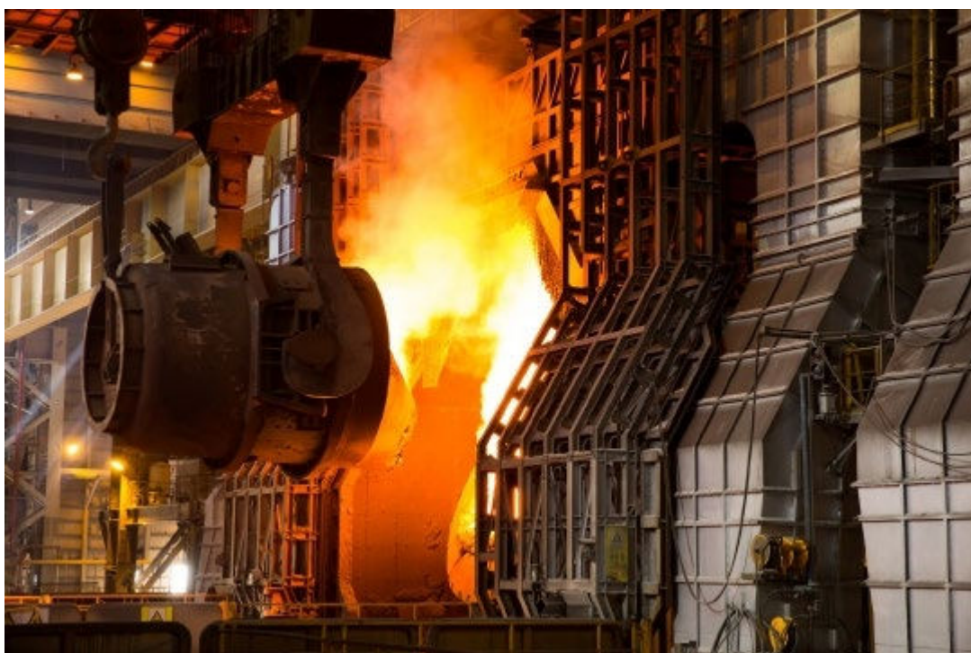
图 24：钢铁生产过程中碱性氧气炉中的铁水（国际钢铁协会，2019）
